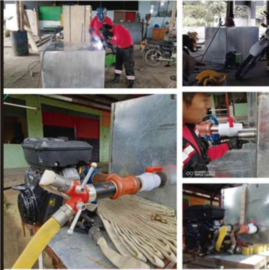
Construcción de bomba de intervención rápida.
